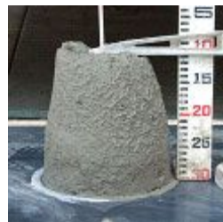
←スランプ値 12 のフレッシュコンクリート
